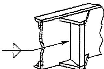
Ребра жесткости, предотвращающие деформацию из плоскости стенки балки, должны иметь конструкцию крепления к полкам с целью передачи усилий от стенки к полкам балки
