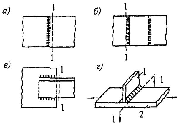
а - встык; б - внахлестку лобовыми швами; в - внахлестку фланговыми швами; г - схема прикрепления поперечного элемента 1 к элементу 2, не имеющему стыка;
