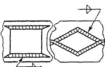
Усилиительная стыковая накладка лучше всего может быть выполнена из элемента ромбовидной формы со швами, проходящими за концевые точки листа. Это снижает максимальные срезающие напряжения в угловых швах по сравнению с прямоугольной накладкой
