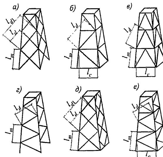
а, б, в - с совмещенными в смежных гранях узлами;
