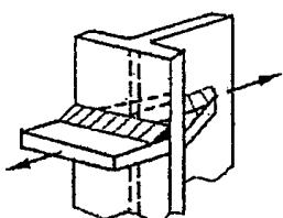
В кронштейнах, прикрепленных к полкам, части полок отдаленные от стенки, воспринимают меньшие усилия, чем часть, примыкающая к стенке. Это приводит к высоким значениям напряжений в центральной части полок. Чтобы распределить напряжения по шву более равномерно, необходима постановка ребер жесткости, передающих нагрузку на стенку основного элемента
