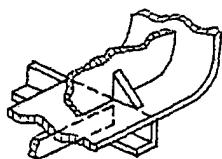
При пересечении главных балок с элементами переборок и перегородок, во избежание возникновения в местах их пересечения высоких местных напряжений необходима постановка поперечных ребер
