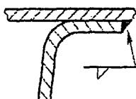
Отбортованные элементы в резервуарах должны быть расположены под прямым углом к привариваемому элементу с целью снижения изгибающих напряжений в сварном шве. Не допускается приварка закругленного конца элемента
