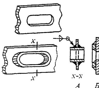
Вырезы должны быть закругленными во избежание концентраторов напряжений в углах. Если в месте выреза предусматривается усиление, то необходимо предусмотреть, чтобы сварной шов являлся достаточным для восприятия всей нагрузки, которая передается на усилительный элемент. Для небольших вырезов следует предпочесть случай "Б" случаю "А", что облегчает подгонку усилительного элемента и улучшает противодействие усталостным напряжениям
